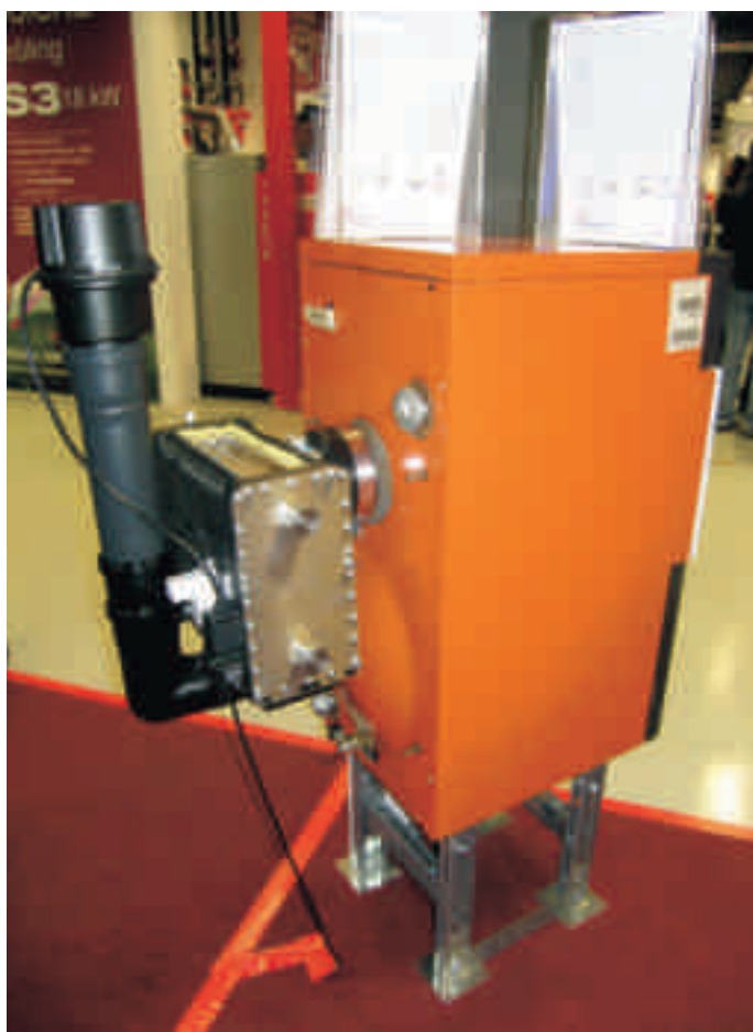
Slika 3 Obstoječemu kotlu lahko dodamo kondenzacijski izmenjevalec
